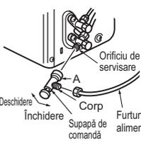
Atunci când se atașează supapa de comandă la orificiul de servizare, centrul supapei poate suferi deformări sau se poate desprinde în cazul aplicării unei presiuni excesive. Acest lucru poate cauza scurgeri de gaz.
