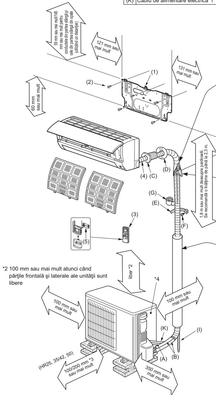
Asigurați-vă că utilizați manșonul pentru orificii realizate în perete (C) pentru a preveni intrarea în contact a cablului de conectare (A) de la unitatea interioară/exterioră cu componentele metalice din interiorul peretelui și pentru a preveni deteriorarea acestuia de către rozătoare în cazul în care peretele este gol.
